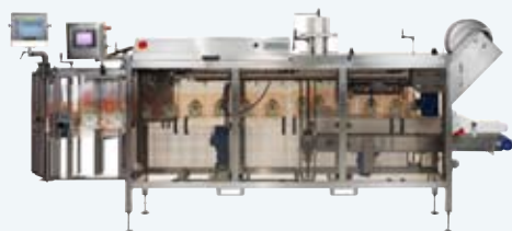
Наполнитель. Пакеты формируются из рулонного полиэтилена
