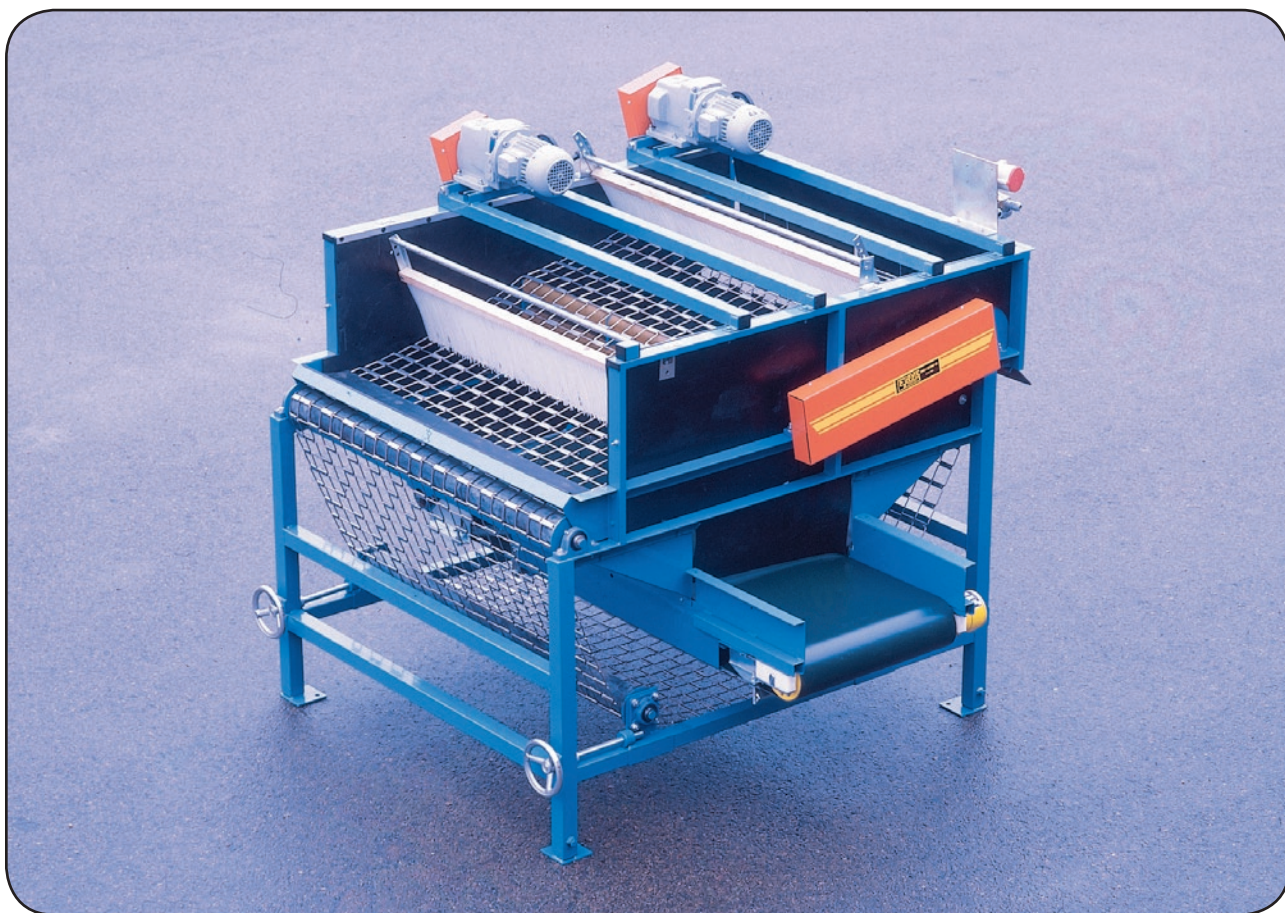
Nätsorterare G B1200 försedd med transportör för utmatning.
